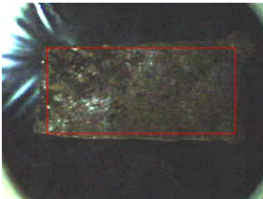
Рис. 2. Звено ремня. Красным выделена область сканирования.
