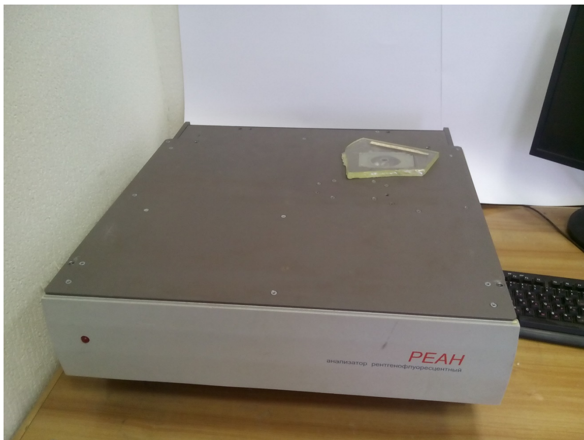
Рис. 22. Процесс измерения. Образец устанавливается непосредственно над областью анализа.
