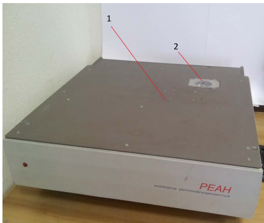
Рис.2 Внешний вид анализатора без автоматического сменщика образцов. 1 – верхняя поверхность аналитического блока, позволяющая установить образец для анализа любого размера; 2 – область анализа (измерительная камера со встроенной видеокамерой, позволяющей навестись на интересующую точку на исследуемом образце).
