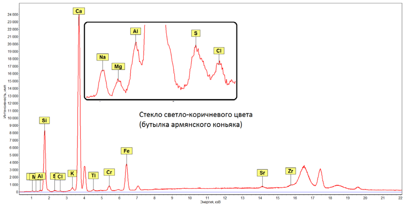
Рис.5 Спектр стекла светло-коричневого цвета (бутылка «Коньяк»), с отмеченными пиками Na, Mg, Al, Si, S, Cl, K, Ca, Ti, Cr, Fe, Sr, Zr.
